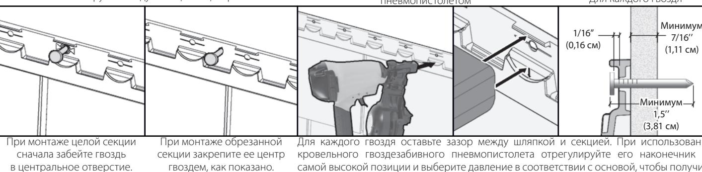
\* Кровельный гвоздезабивной пневмопистолет, такой как Bostitch RN46 или Hitachi NV45
