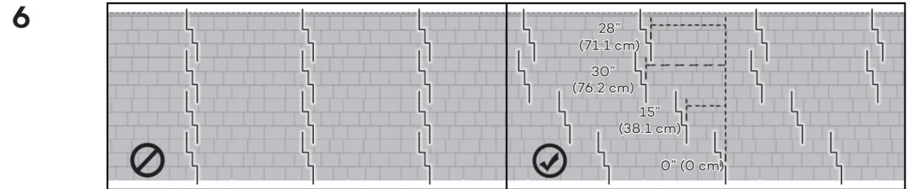
Alterne las juntas entre las hileras. Para una apariencia más agradable, sugerimos que alterne la distancia de corte de la primera sección de cada hilera de 0" (0 cm) - 15" (38.1 cm) - 30" (76.2 cm) - 28" (71.1 cm).
