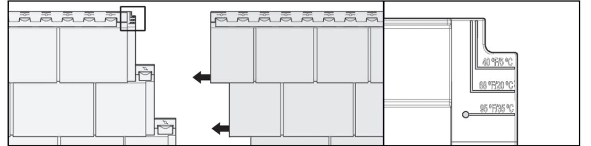
Menos de 40 °F (5 °C), coloque la sección ligeramente hacia la derecha (1/16" (0.16 cm) de la línea de temperatura 40 °F (5 °C).
