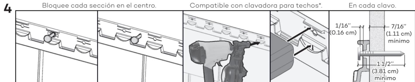
Cuando se instale una sección completa, clave primero el orificio central. Cuando instale una sección cortada, clave el centro como se muestra. En cada clavo, deje un espacio entre la cabeza del clavo y la sección. Cuando use una clavadora para techos, ajuste la punta a su posición más alta y la presión del aire según el sustrato a fin de dejar el espacio requerido.
