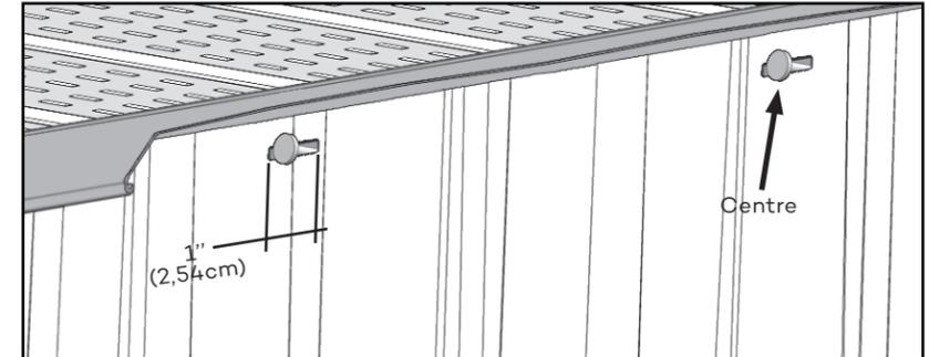
Si vous devez fixer les sections dans un endroit autre que dans les trous de fixation, faire une fente de 1"(2,54 cm) pour permettre de clouer. Toujours clouer au centre de la fente.
