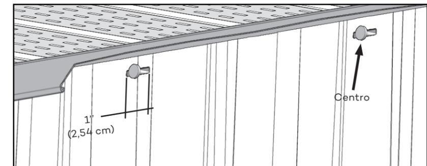
Se precisar fixar a seção em uma área diferente do furo de instalação, crie uma abertura de 1" (2,54 cm) para permitir a entrada do prego. Sempre coloque o prego no meio da abertura.
