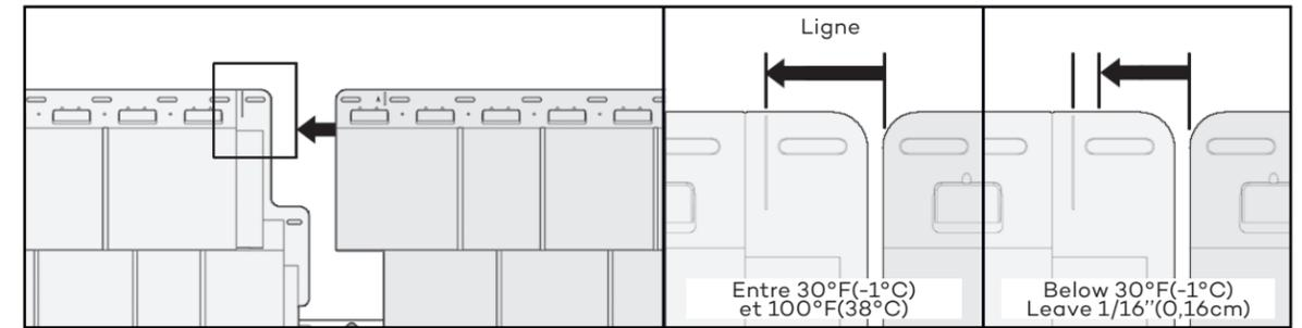
Pour des température inférieure à 30°F(-1°C), positionner la section légèrement à droite (1/16" (0,16cm)) de la butée.
