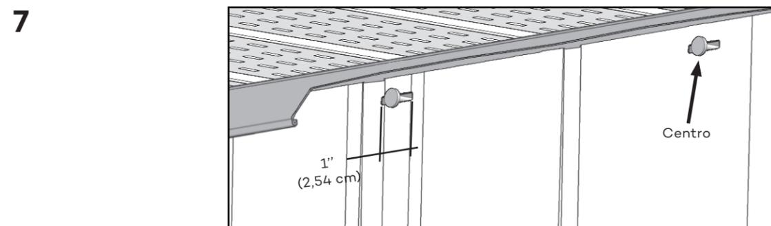
Se precisar fixar a seção em uma área diferente do furo de instalação, crie uma abertura de 1" (2,54 cm) para permitir a entrada do prego. Sempre coloque o prego no meio da abertura.
