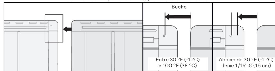
Abaixo de 30 °F (-1°C), posicione a segunda seção levemente à direita (1/16", ou 0,16 cm) do batente.
